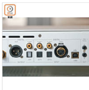
能透過USB插口播放數碼音樂檔，提供最高32-bit 384kHz PCM及DSD256解碼。
